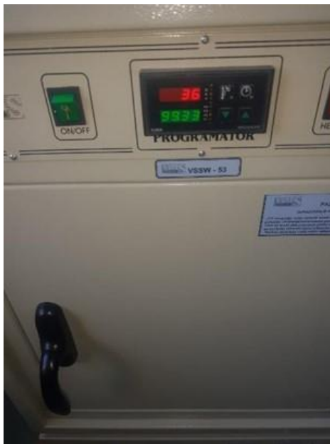
Слика 7: Лабораторијска комора коришћена за загревање узорака
