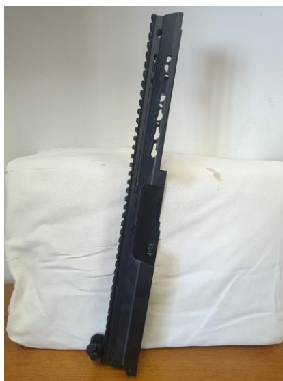
Слика 27: Поклопац склопа за пушку М19
