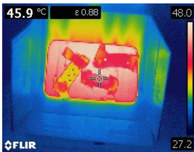
Слика 14: Инфрацрвени снимак компоненти пиштоља М57
