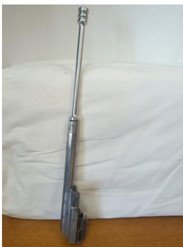
Слика 15: Носач затварача за јуришну пушку М70
