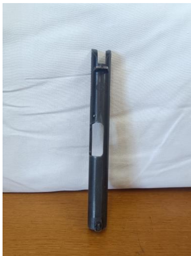
Слика 25: Навлака са предњим и задњим нишаном за пиштољ М57
