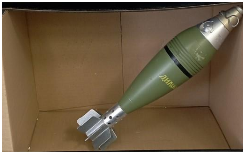
Слика 6: Лабораторијски узорак – минобацачка мина 60 mm M57 са SMB превлаком и причвршћеном траком високе емисивности
