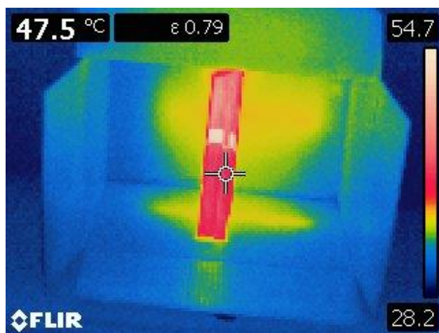
Слика 26: Инфрацрвени снимак навлаке са предњим и задњим нишаном за пиштољ М57
